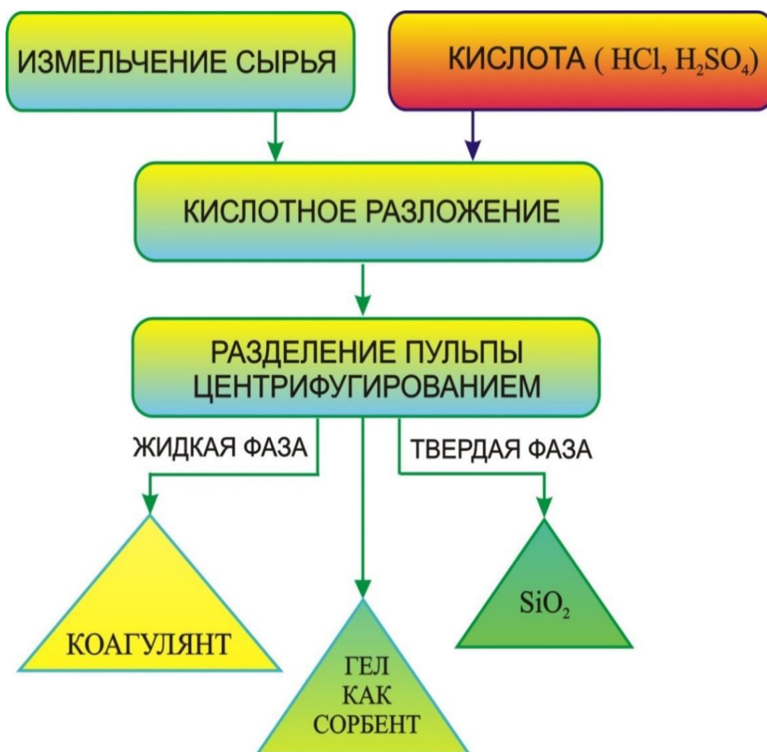
Рисунок 1.5. - Обобщённая упрощённая технологическая схема по кислотной переработке цеолитовой руды
